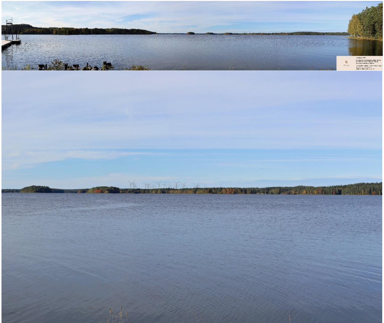
Kuva 10.16. Havainnekuva Riuttaniemeltä. Etäisyys voimaloihin on noin 13–19 kilometriä. Alla oleva kuvakulma vastaa kinofilmikoon 50 mm objektiivin kuvakulmaa. Järven avarassa maisematilassa voimalat nousevat selvästi esiin horisontissa metsärajan yläpuolella maaston korkeuserojen takia. Etäisyyden takia voimalat asettuvat osaksi laajempaa maisemakokonaisuutta eivätkä täytä näkökenttää, mikä lieventää niiden hallitsevuutta maisemakuvassa. Tuulivoimalat tuovat kuitenkin järvimaisemaan uuden, selvästi havaittavan rakennetun kerroksen. Järven rannalta avautuvassa maisemassa on myös nykyisiä tuotannossa olevia tuulivoimaloita. Kuvauspäivä 18.9.2023.
